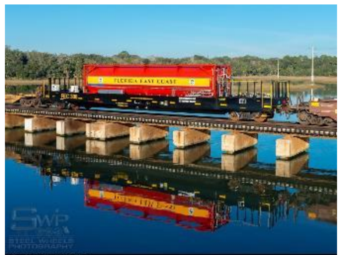
FEC Rwy LNG tender #300 to be mated with a GE ES44C4 for LNG fuel test in 2016
